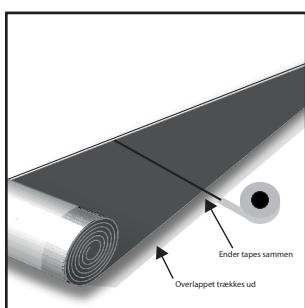
Overlappet "strækkes" ud inden den efterfølgende bane rulles ud (oven på overlappet)
